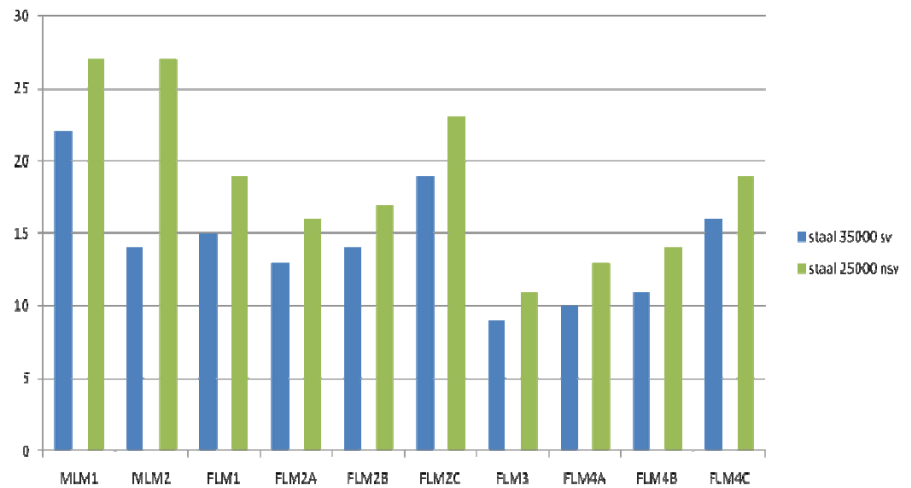
Figuur 4: Delta Sigma [N/mm 2 ] in de onderste vezel van het stalen trogprofiel bij de verschillende belastingmodellen uit NEN 6706
